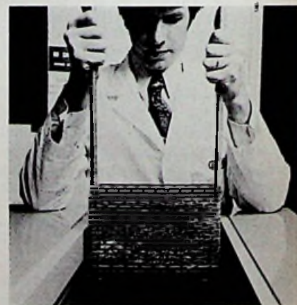
Transistoren worden in „Freon“ T-DA35 droogmiddel gedompeld en vervolgens in „Freon“ TF gespoeld.
